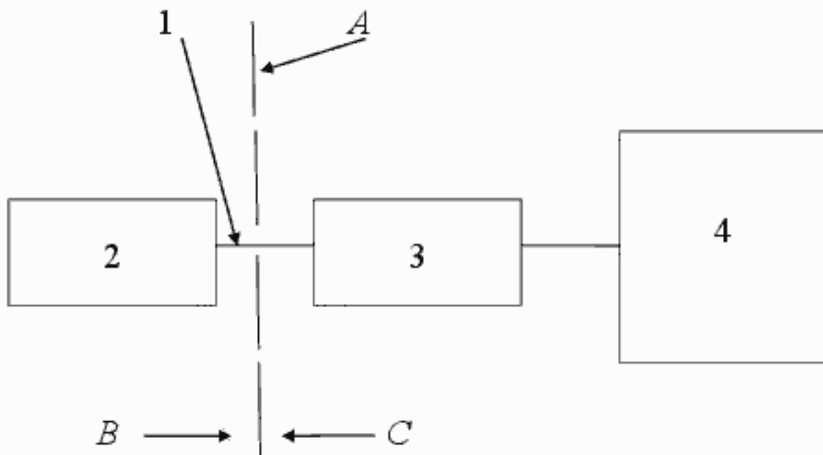
*A* – граница между лифтом и системой сигнализации здания; *B* – здание;
