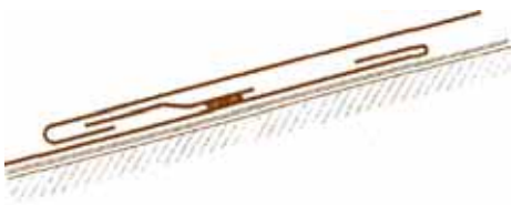
Одинарный удлиненный леокачий фальц с креплением и капиллярной защитой
