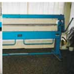
Загибочные станки-прессы используются для сгибания тонколистового металла с конкретными углами сгиба.
