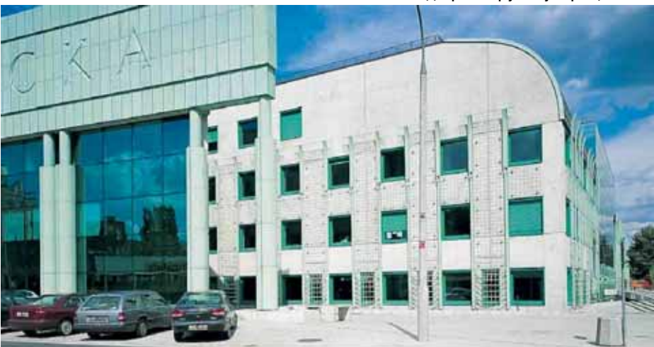
Фасад, патинированный по методу Nordic Green PLUS
