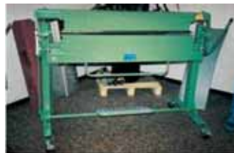
Станок коробчатого сгиба для производства временных перемычек и т.п.
