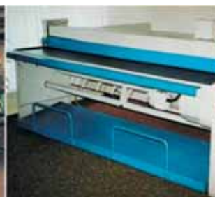
Механические ножницы для обрезки листов по размеру.
