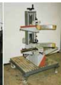
Кругло-загибочный станок. Закругленная предварительно фальцованная металлическая полоса.
