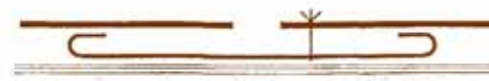
Соединение - край к краю с уплотнительной лентой. Такое размещение считается более предпочтительным, когда используется толстый листовый материал.
