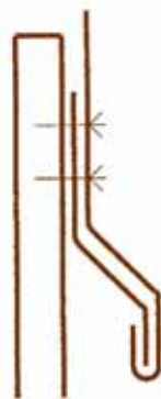
Выступающий угловой отлив поверх медного профиля
