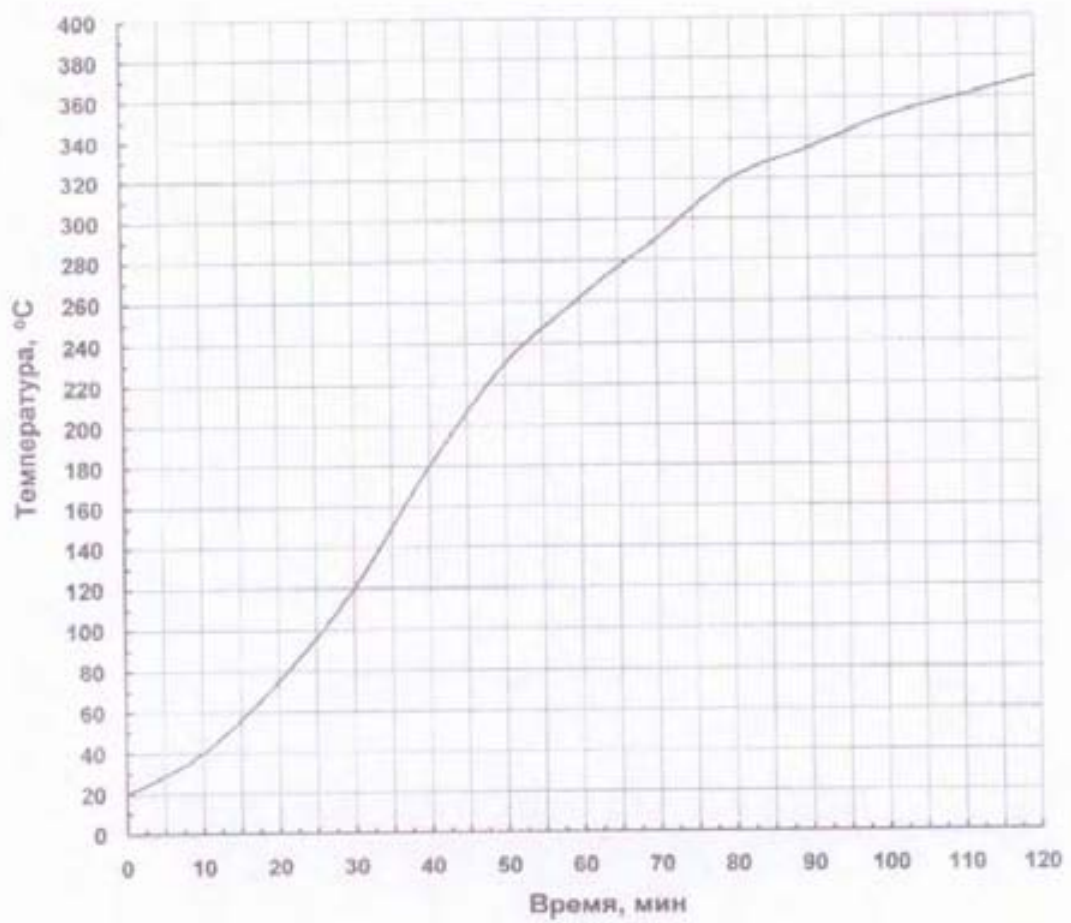
Рисунок 1. Прогрев необогреваемой поверхности сплошной плиты толщиной 50 мм из тяжелого бетона (плотность - 2330 кг/м 3 , влажность - 2,0 %) на гранитном заполнителе
